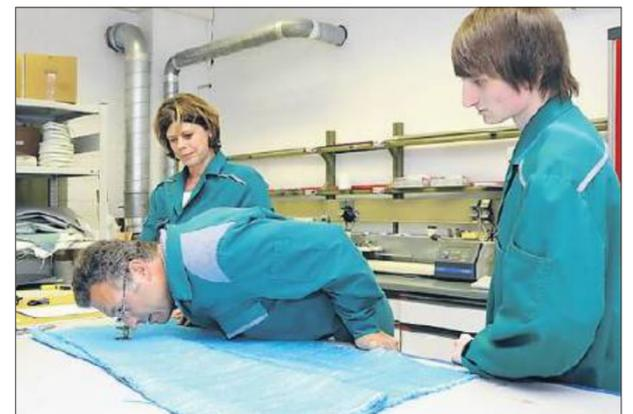
Die Kett- und Schussdichte wird überprüft.
