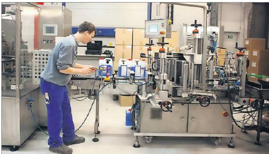
In der Werkhalle werden die Sensoren einer Abfüllanlage eingestellt.
