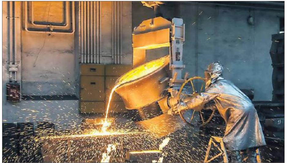
Mit einer Vorrichtung wird flüssiges Eisen in eine Form gegossen.
