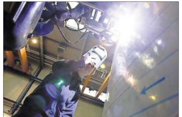
Der Konstruktionsmechaniker überwacht die zuvor programmierte Arbeit des Schweißroboters. Foto: berufenet
