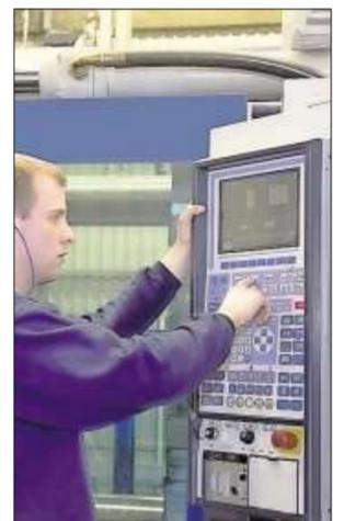
Eine Spritzgießanlage wird programmiert. Foto: berufenet
