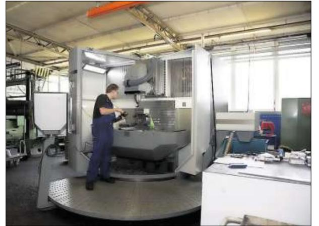
Ein Werkstück wird in der Werkstatt in eine Fräsmaschine eingespannt. Foto: berufenet
