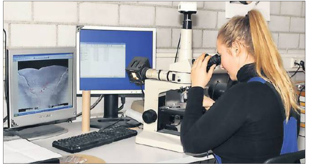
Am Elektronenmikroskop wird das Gefüge einer Schweißnaht geprüft.
