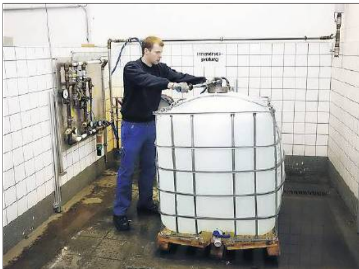
Ein fertiger Tank muss einer Innendruckprüfung unterzogen werden. Foto: berufenet
