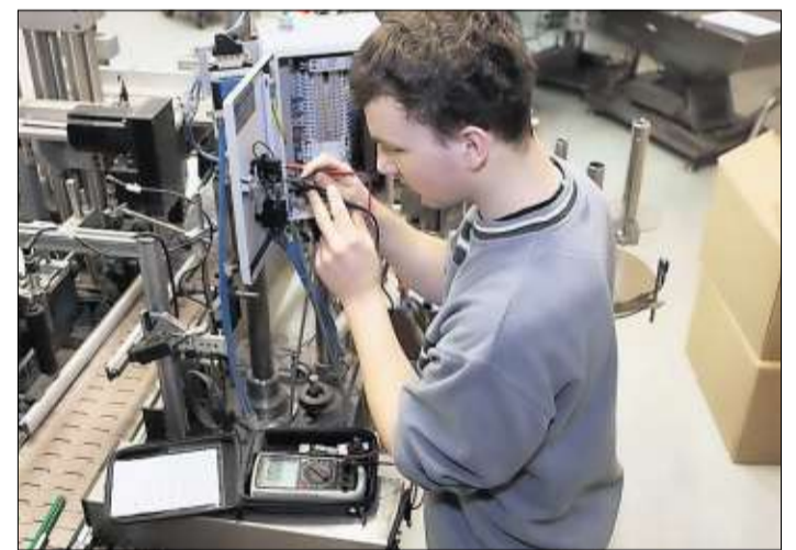
Die Stromdurchgängigkeit eines Schutzleiters messen Foto: berufenet
