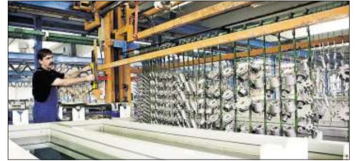
Anlage für das Beschichtungsverfahren vorbereiten
