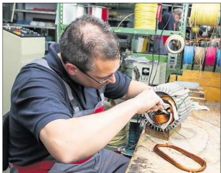
Drahtwicklungen werden in einen Motor eingebaut. Foto: berufenet
