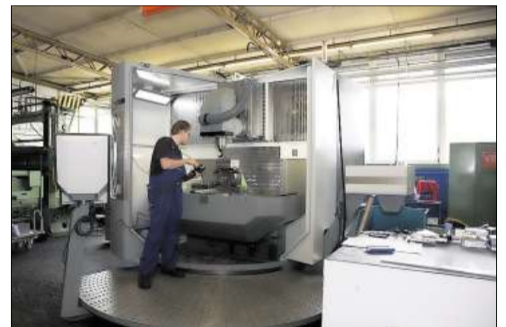
In der Werkstatt wird ein Werkstück in die Fräsmaschine eingespannt.
