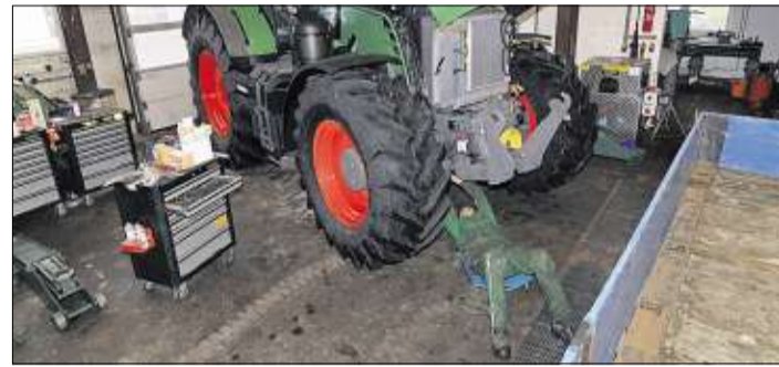
In der Werkhalle wird die Hydraulik eines Traktors nach einem Defekt instand gesetzt. Foto: berufenet
