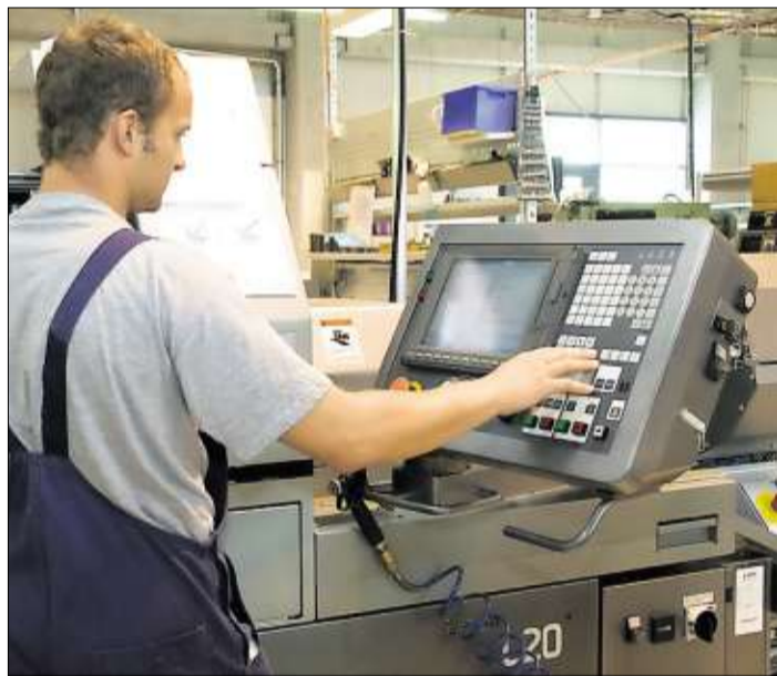
Ein CNC-Langdrehautomat wird programmiert. Foto: berufenet
