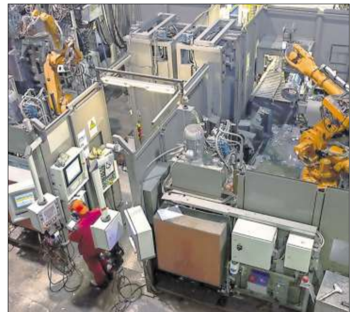
In der Gießhalle wird eine Druckgussanlage eingestellt. Foto: berufenet
