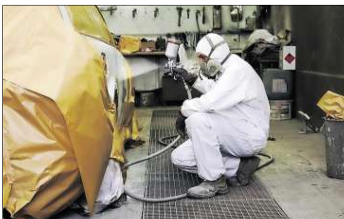
Hier wird die Seitentür eines Fahrzeuges lackiert. Foto: berufenet
